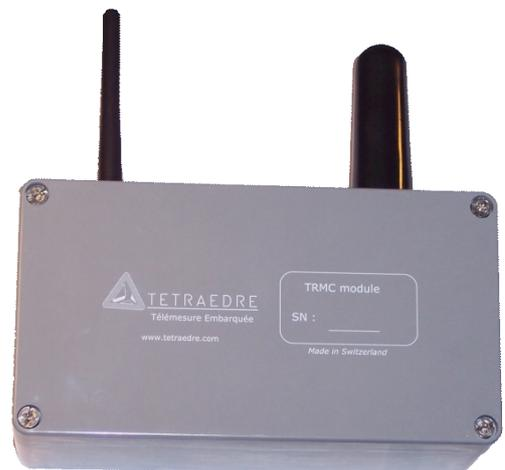
L'appareil fonctionne de manière totalement autonome. Sa faible consommation d'énergie permet un fonctionnement sur batterie (intégrée), pendant plusieurs années. Il n'est donc pas nécessaire d'amener une alimentation au module. Tetraedre propose une version avec des piles lithium pour une autonomie maximale ou une utilisation avec des accumulateurs rechargeable pour réduire les coûts d'exploitation.
