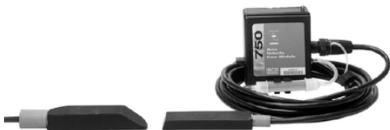
**Mesure de hauteur avec le capteur de vitesse** – Le capteur de vitesse est composé d'une coque moulée. Outre les deux transducteurs ultrasoniques, le capteur contient un transducteur de pression différentielle qui détecte la pression hydrostatique produite par le liquide au-dessus du capteur. Le transducteur convertit la pression en signaux analogiques et envoie les signaux au 750.
